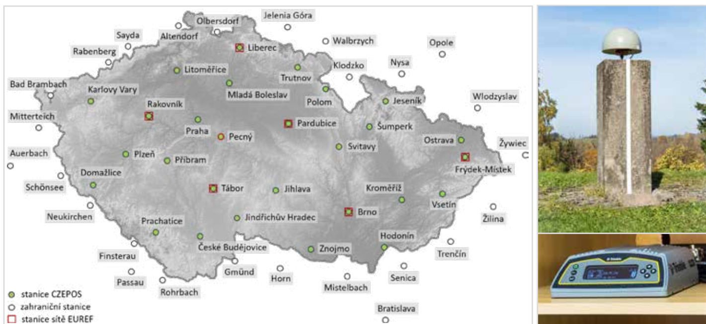
Obr. 2 Schéma rozmístění permanentních stanic GNSS České republiky (vlevo); vojenskou permanentní stanicí Polom zapojenou do CZEPOS tvoří přijímač Trimble Alloy s anténou Trimble GNSS Ti-V2 Choke Ring (vpravo)
