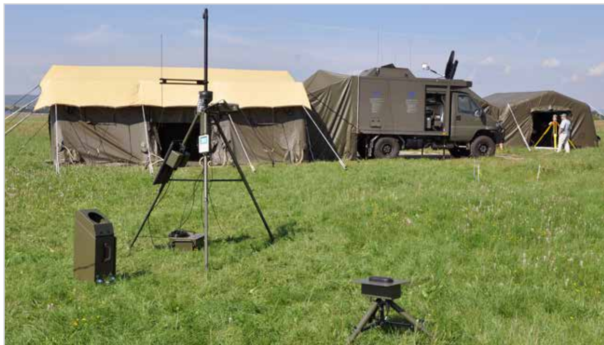
Obr. 21 Rozvinutá mobilní hydrometeorologická stanice BLESK
