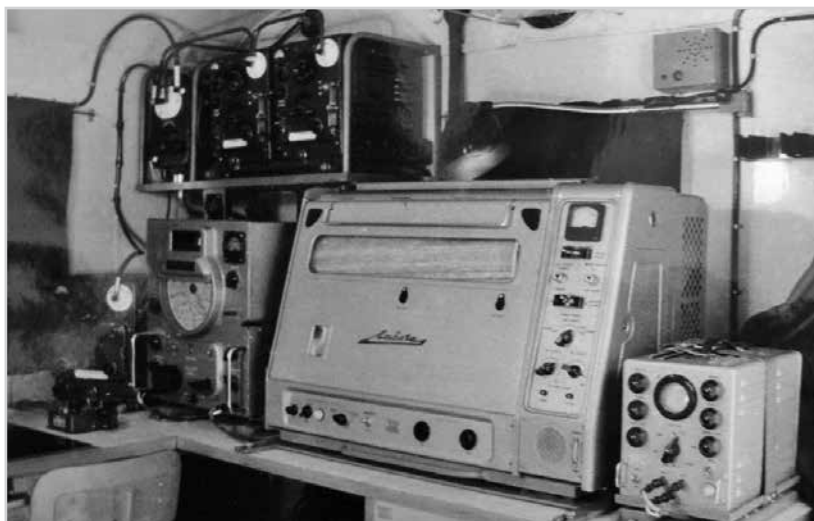
Obr. 2 Zástavba pojízdňné letecké meteorologické stanice LPS-65 (na spodní pracovní desce zleva: radiový přijímač VOLNA-K, fototelegrafická stanice FTAK 2P-Ladoga a osciloskopický přístavek OP-59)
