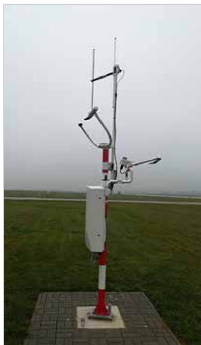
Obr. 16 Senzor měření dráhové dohlednosti na letecké základně
