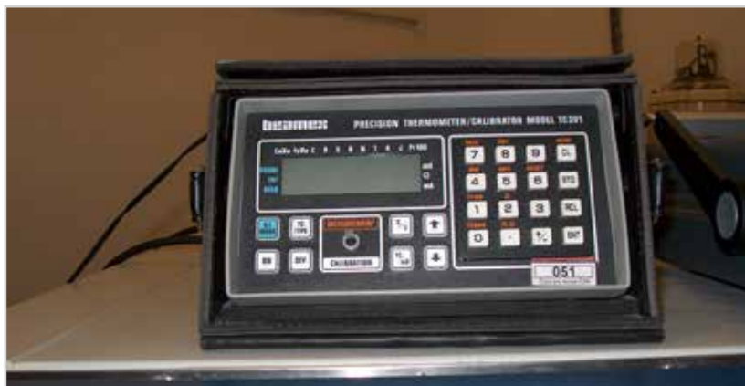
Obr. 8 Etalon teploty – teplotní kalibrátor BEAMEX TC 301
