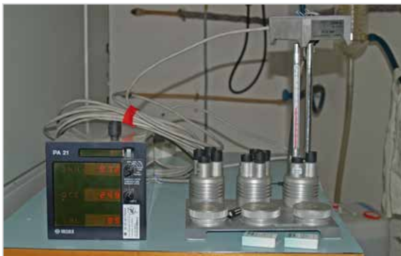
Obr. 2 Barometr PA-21 v barometrické komoře
