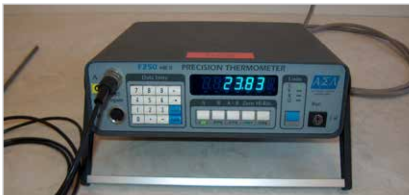
Obr. 7 Etalon teploty – precizní teploměr F 250MK II
