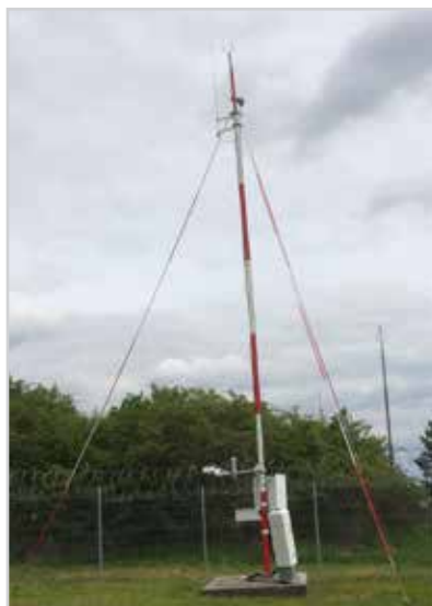
Obr. 5 Nová stacionární automatická letecká meteorologická stanice AWS 310 SITE v Plzni-Líních
