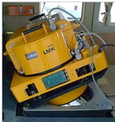
Obr. 18 Kamera pro letecké měřické snímání řady LMK
