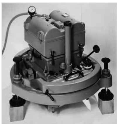
Obr. 11 Od roku 1956 byly pro pořizování LMS používány kamery Wild RC5 s délkou ohniska f = 120/210 cm a formátem snímku 18 × 18 cm
