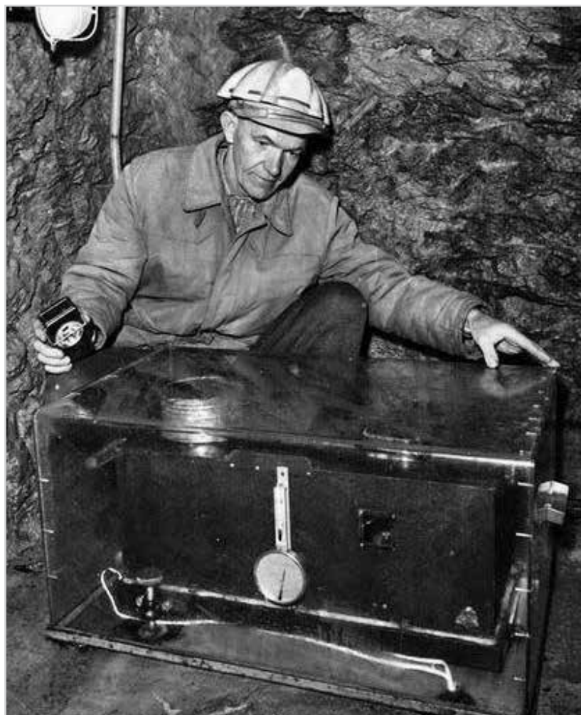
Obr. 2 Údržba seizmometru na stanici Kašperské Hory v 60. letech minulého století (zdroj: http://casopis.vesmir.cz/clanek/jubileum-seizmické-stanice-kasperske-hory )
