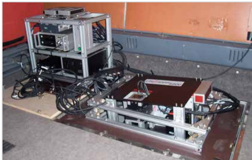
Obr. 20 Systém LiteMapper 6800 pro provádění leteckého laserového skenování na jeho palubě letounu Let L410 FG
