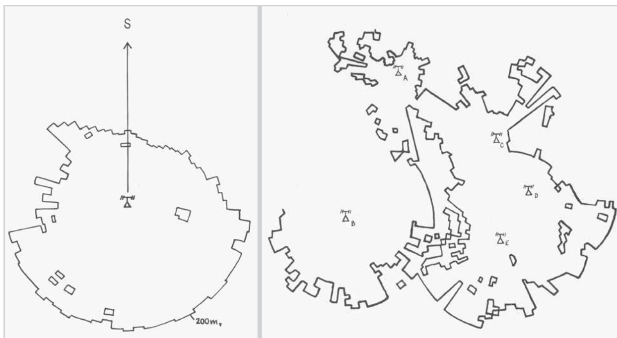
Obr. 1 Ukázka možností využití digitálního modelu reliéfu ke zjišťování dosahu, případně hluchých míst radiolokátoru v různých výškových hladinách (vlevo výpočet a zobrazení radiolokačního diagramu pro radiolokátor zvoleného typu, umístěný na konkrétním stanovišti o souřadnicích x, y, z pro případ sledování letícího cíle, který se snaží kopírovat terén, vpravo výpočet a zobrazení obdobné úlohy pro radiolokační pole vytvářené více radiolokátory)
