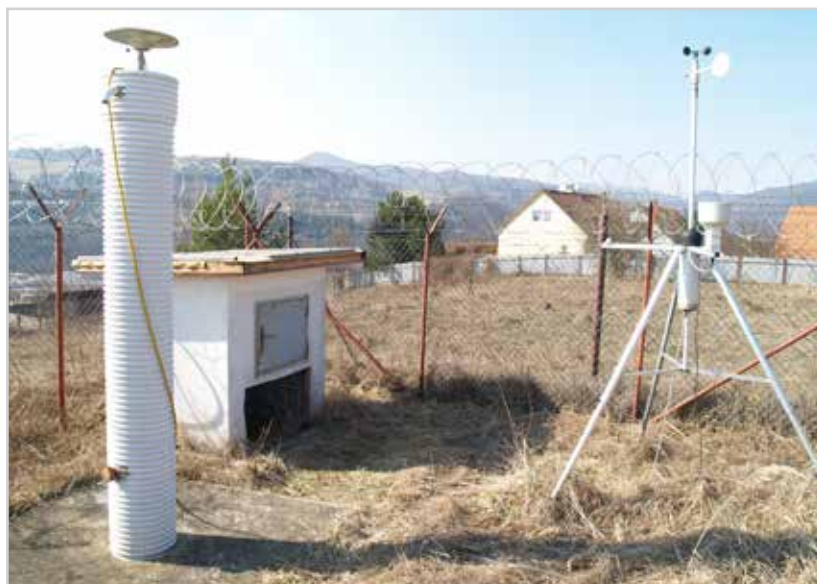
Obr. 4 Geobod a meteostanica TOPÚ napojené na medzinárodnú sieť EPN
