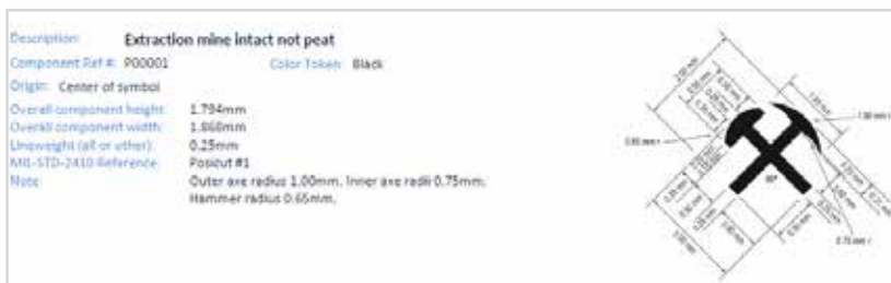
Obr. 2 Ukázka specifikace rozměrů bodové značky pro lom
