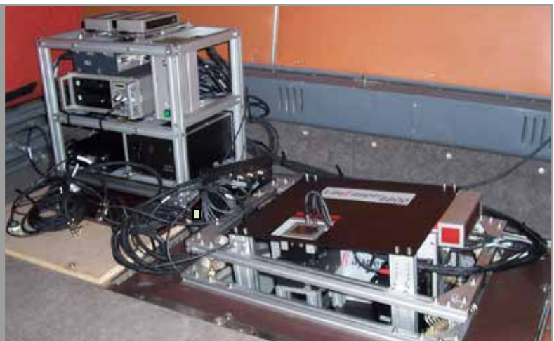
Obr. 5 Letecká měřická kamera Leica ADS 100 Airbone Digital Sensor (vlevo) a systém laserového skeneru LiteMapper 6800 instalovaný na palubě letounu Let L-410FG Turbolet (vpravo)
