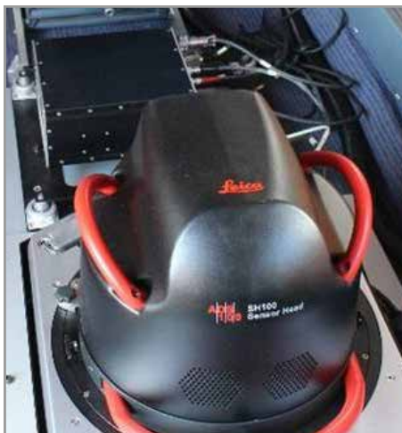
Obr. 5 Letecká měřická kamera Leica ADS 100 Airbone Digital Sensor (vlevo) a systém laserového skeneru LiteMapper 6800 instalovaný na palubě letounu Let L-410FG Turbolet (vpravo)
