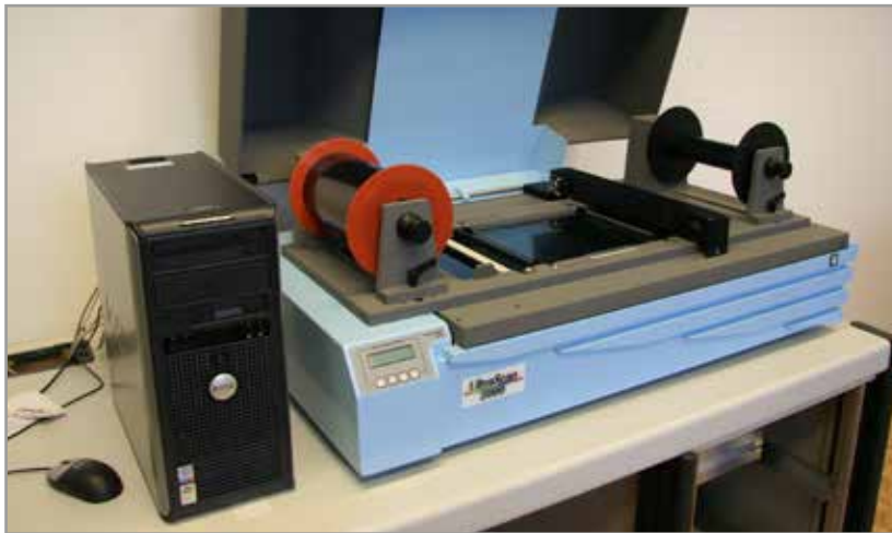
Obr. 6 Fotogrammetrický skener UltraScan 5000
