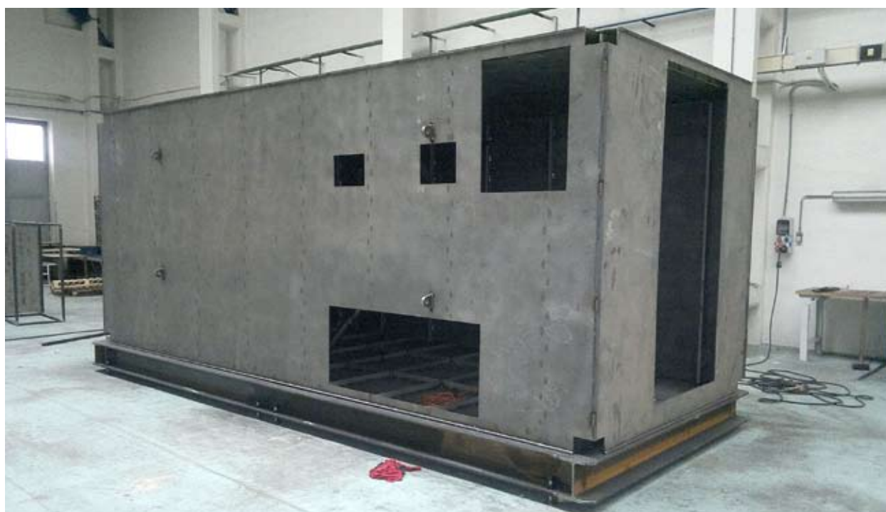
Obr. 2 Výroba pancěřového skeletu
