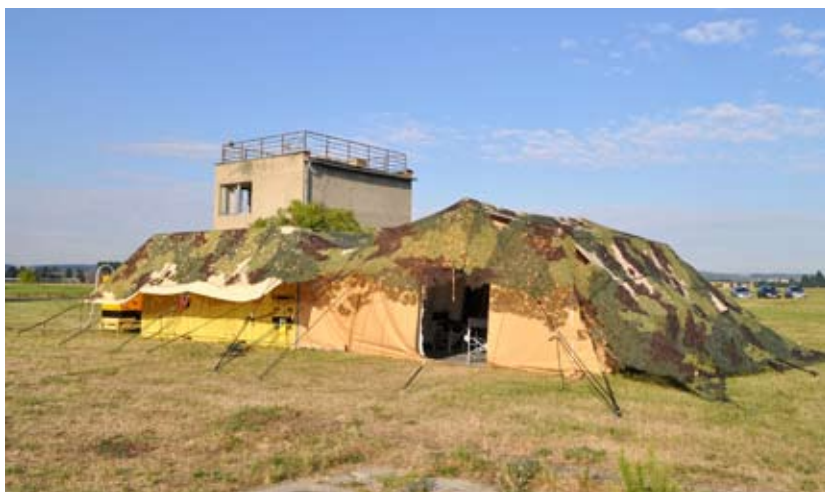
Obr. 11 Mobilní souprava geografického zabezpečení GeMoZ-C v rozvinutém stavu
