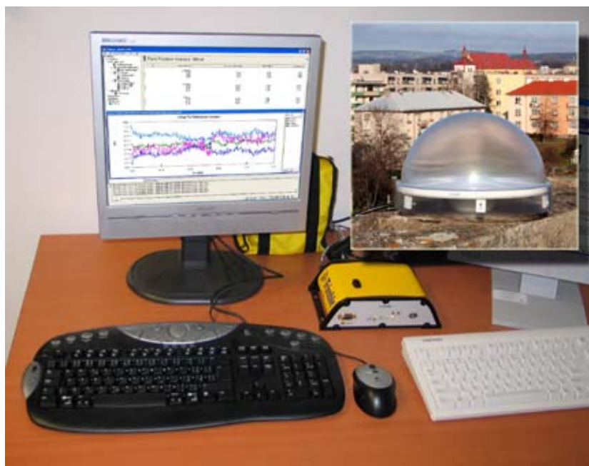
Obr. 5 Základní vybavení permanentní stanice GPS na pracovišti GISS AČR (vpravo nahoře anténa referenční stanice GPS Zephyr Geodetic, na pozadí přijímač GPS Trimble NetRS a řídicí software GPSBase)
