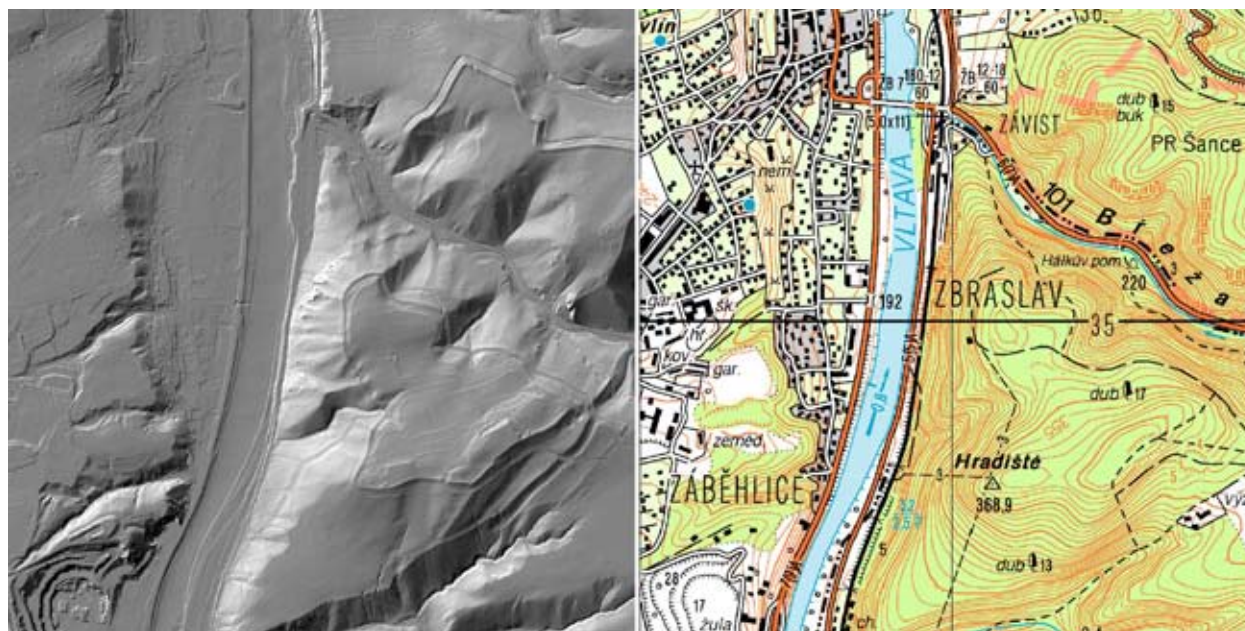
Obr. 8 Výsledkem spolupráce GeoSI AČR a ČÚZK je mj. nový výškopis ČR – na obrázcích digitální model reliéfu v podobě stínovaného modelu (vlevo) vytvořený s využitím dat leteckého laserového skenování a jeho porovnání s výřezem Topografické mapy 1 : 25 000 identické lokality (zmenšeno)
