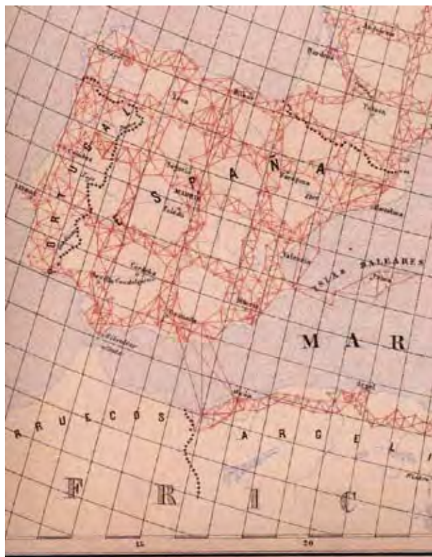
Obr. 23 Výstavba geodetických základů Španělska prostřednictvím řetězců s připojením severního pobřeží Afriky [10]
