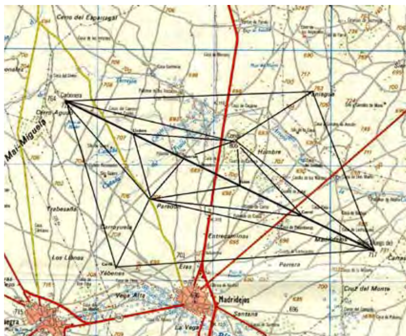
Obr. 17 Základna Madrudejos a její poloha pro rozvíjení trigonometrické sítě [16]
