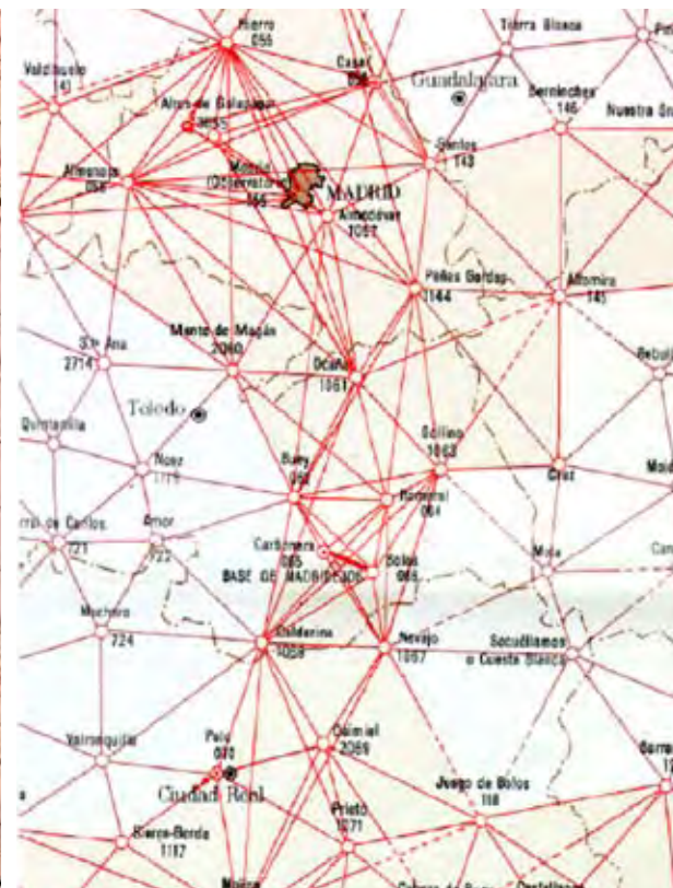
Obr. 24 Velké úsilí bylo následně věnováno rozvíjení triangulačních sítí I. a II. řádu a postupnému zhušťování geodetických základů [10]
