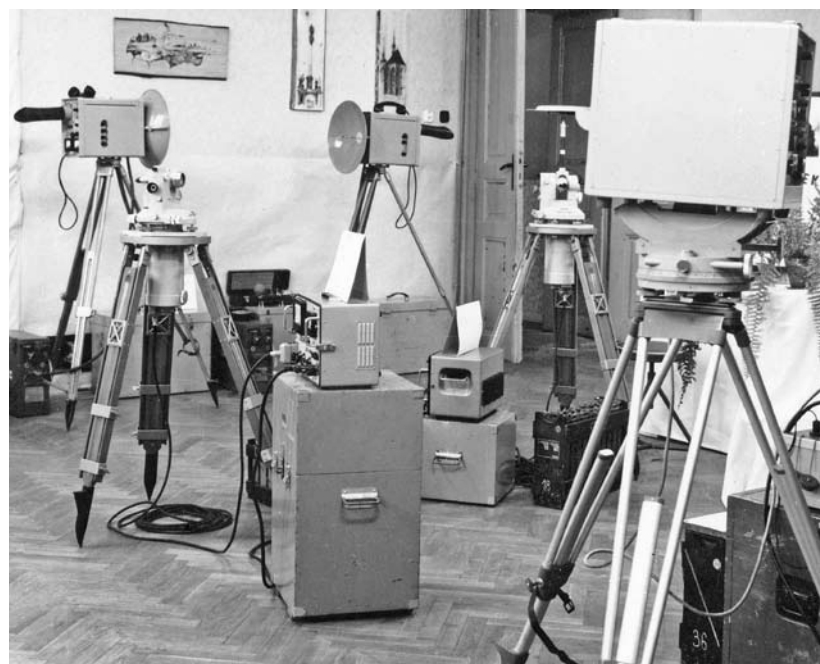
Obr. 4 Před příchodem elektrooptických dálkoměrů byly oporou při měření délek tellurometrie
