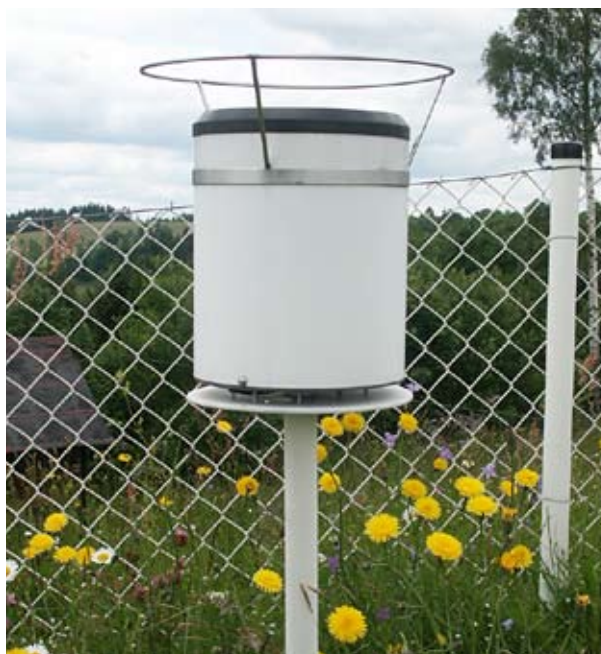
Obr. 2 Člunkový srážkoměr MR3H-F
