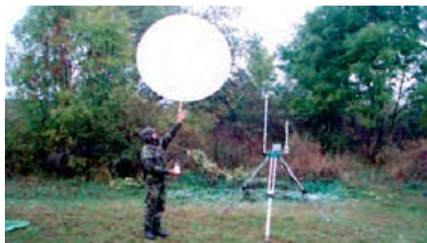
Obr. 4 Vypouštění meteorologické sondy – DigiCora III
