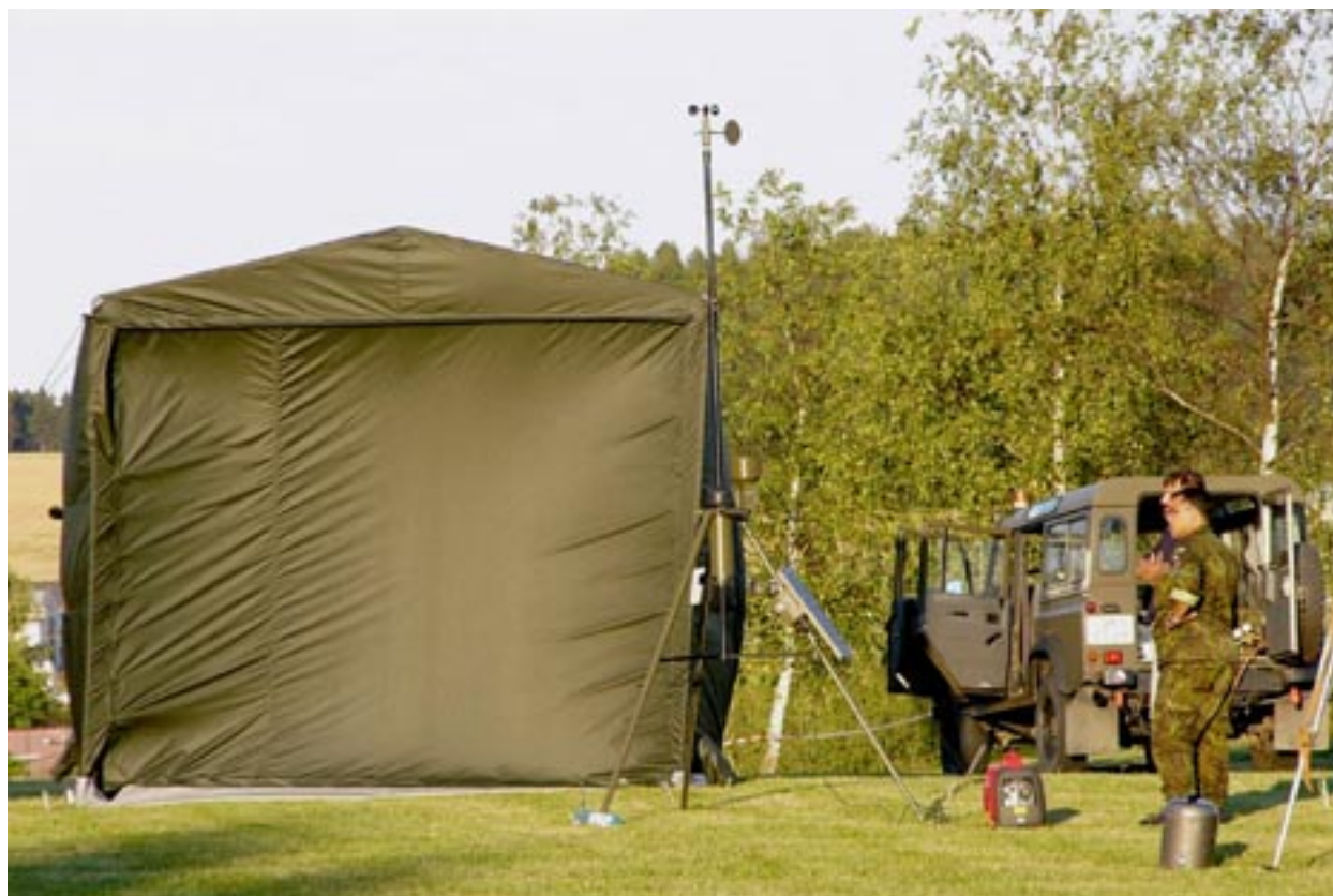
Obr. 4 Rozvinutá mobilní sondážní stanice se stanovým přístřeškem, stanicí MAWS TACMET a automobilem LR 110
