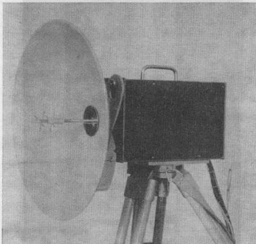
Obr. 4. Vysílací a přijímací blok GET-B1 po úpravě
