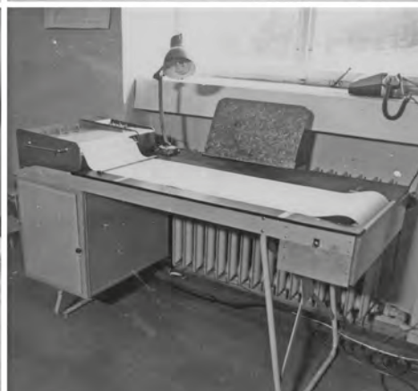
Obr. 21 Souprava sovětského seizmometru na stanici Sedloňov-Polom
