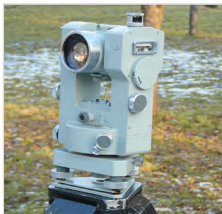
Obr. 19 Měření s rádiovým dálkoměrem GET-B1
