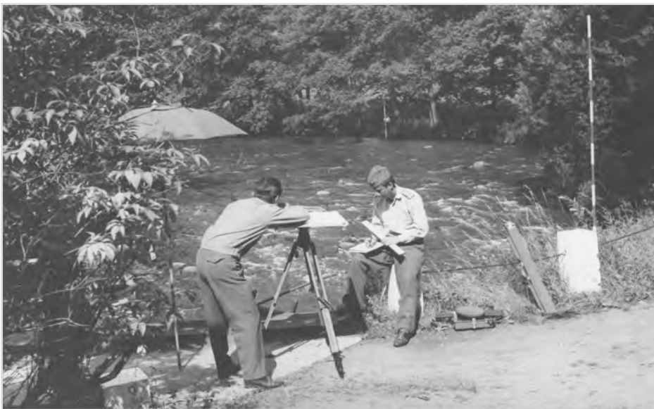
Obr. 17 Mapovací práce prováděné metodou stolové tachymetrie
