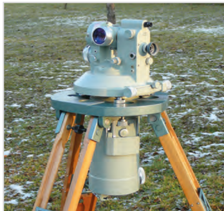
Obr. 20 Klasická geodetická technika VTOPÚ z osmdesátých let – shora teodolit Zeiss Theo 010, elektronický tachymetr Recota a gyroteodolit Gi-B2
