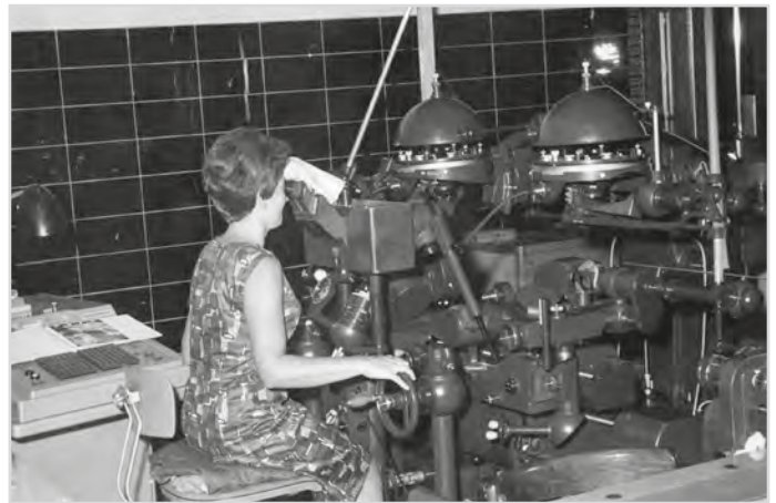
Obr. 16 Univerzální stereofotogrammetrické vyhodnocovací přístroje Stereoplanigraf C-5 firmy Zeiss tvořily základní vybavení fotogrammetrického odboru při topografickém mapování
