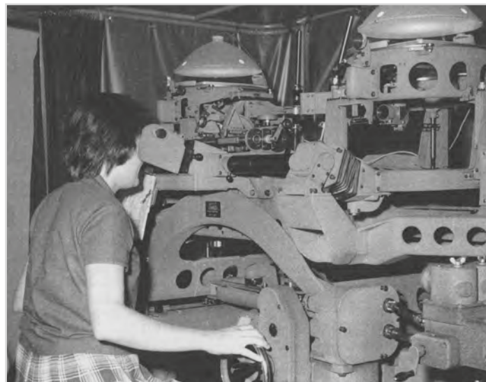
Obr. 11 Vyhodnocení polohopisu a výškopisu na univerzálním fotogrammetrickém přístroji Wild A8
