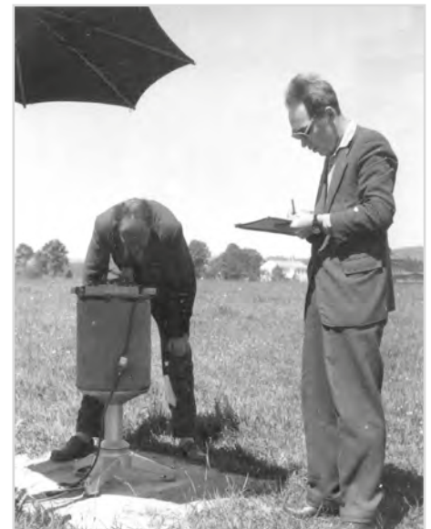
Obr. 18 Měření gravimetrem ASKANIA Gs12
