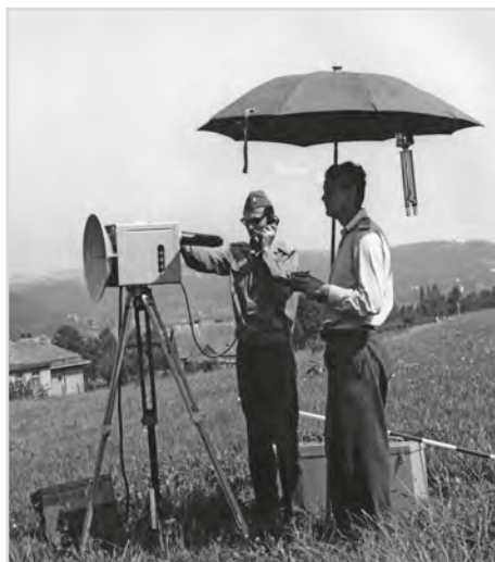
Obr. 19 Měření s rádiovým dálkoměrem GET-B1
