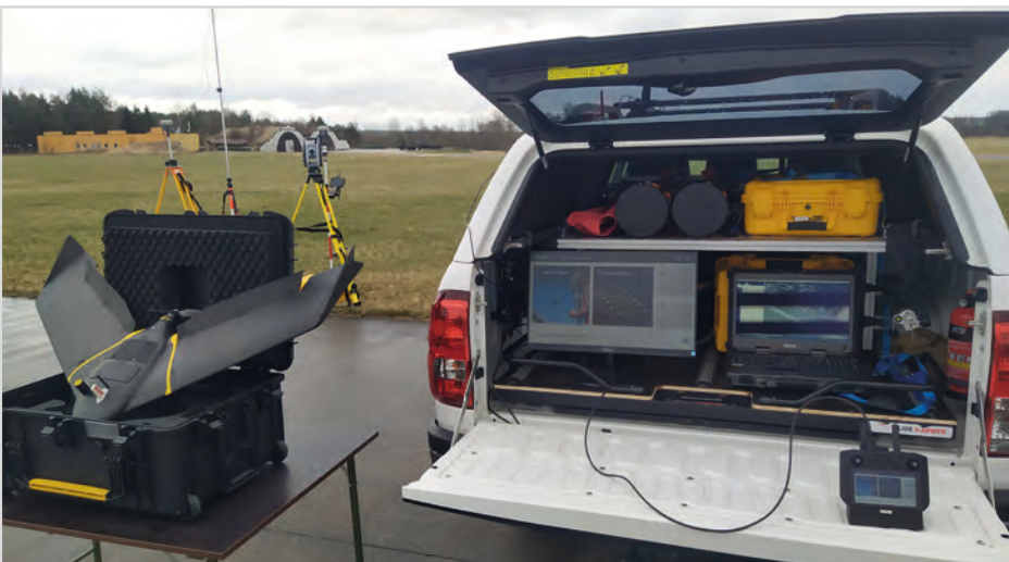
Obr. 34 Aktuálně nejmodernější mobilní prostředek VGHMÚř – Geodeticko-topografická souprava postavená na bázi vozidla Toyota Hilux
